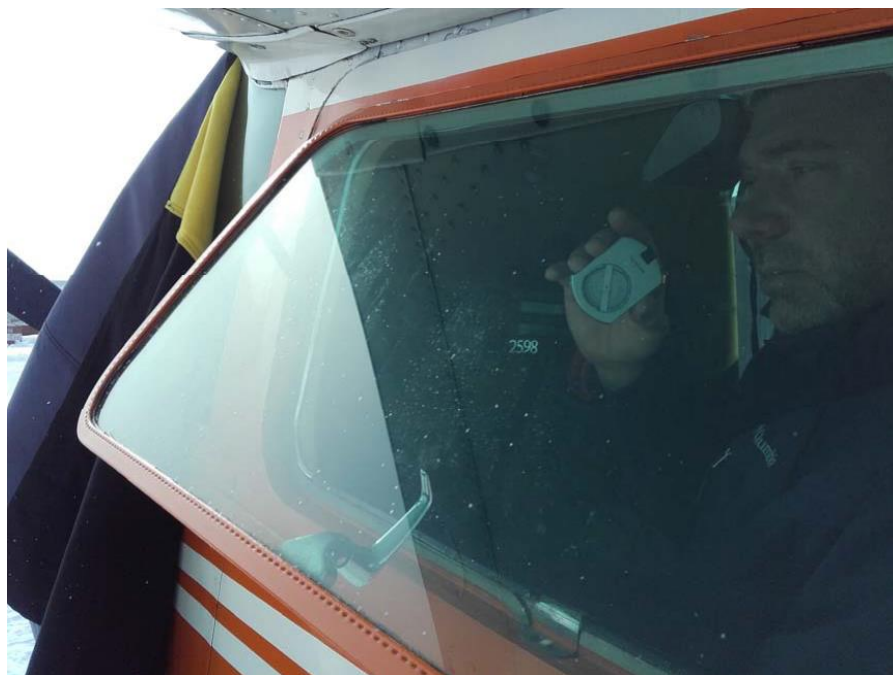
Рисунок 30. Использование клинометра для маркировки подкосов для определения учетной полосы и интервалов
