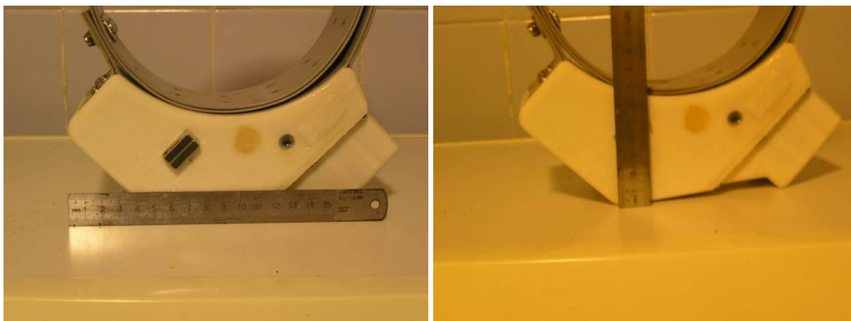
Рисунок 31. Габариты радиомаяка для мечения оленей
