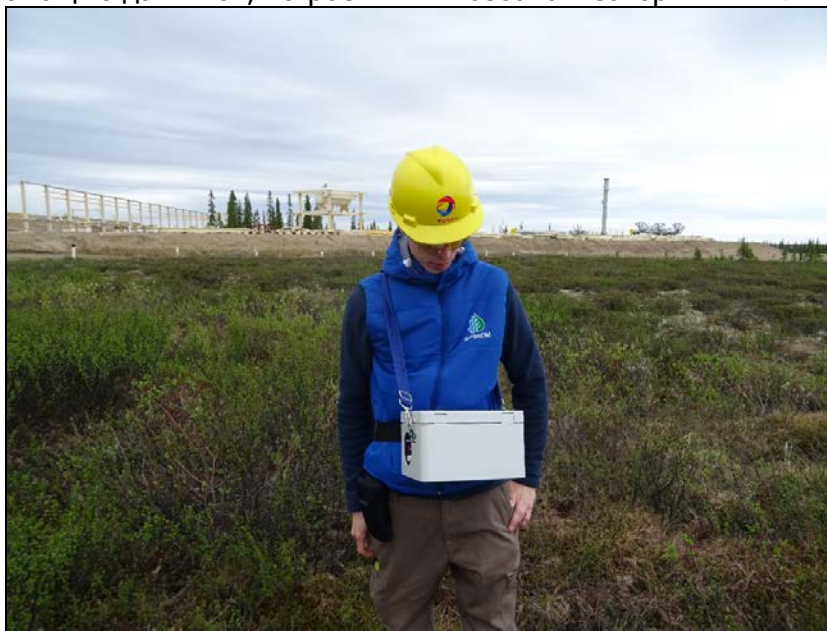
Рисунок 4.2-3. Отбор проб воздуха газоанализатором «ГАНК-4»
