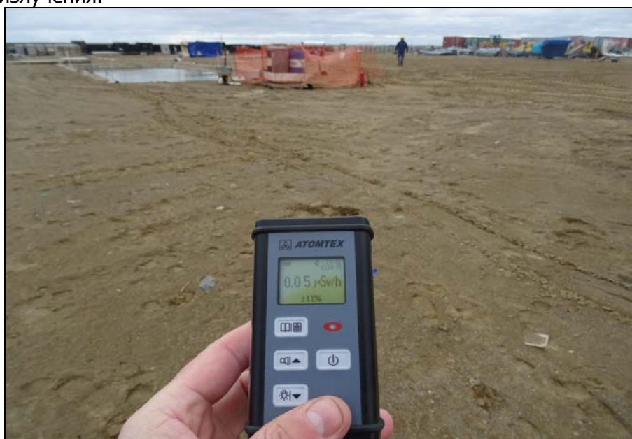
Рисунок 4.2-4. Измерение МЭД дозиметром-радиометром МКС-АТ6130Д на точке КН-07/16
