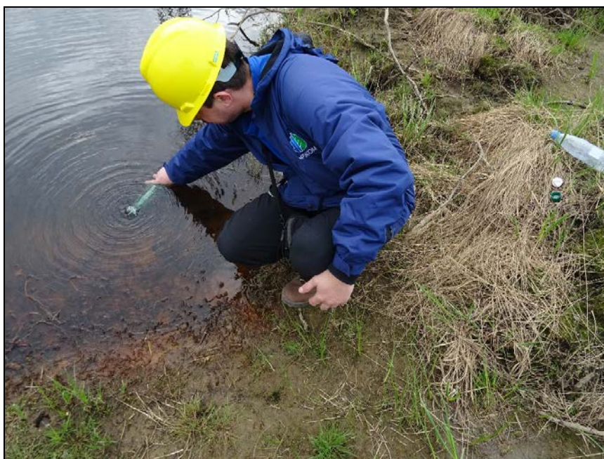
Рисунок 4.2-2. Отбор проб поверхностных вод и донных отложений
