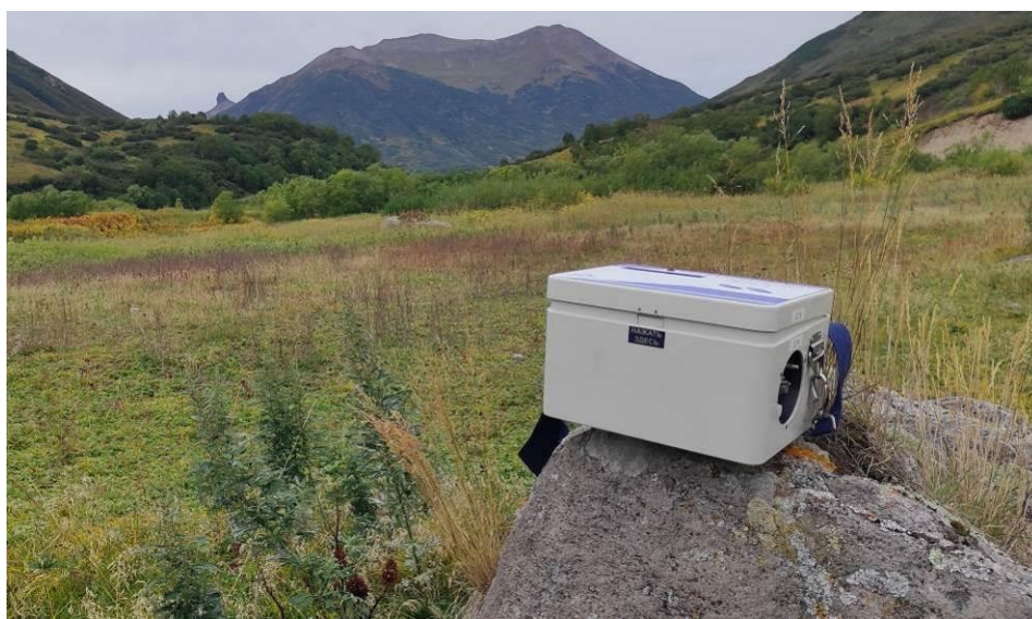
Рисунок 2.4-1. Измерение загрязнения атмосферного воздуха с использованием ГАНК-4
