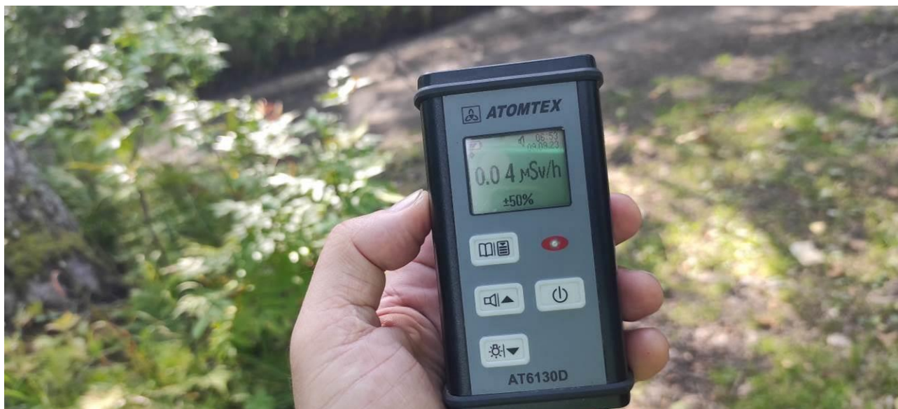
Рисунок 2.4-3. Измерение МАД гамма-излучения с использованием дозиметра МКС-АТ6130D
