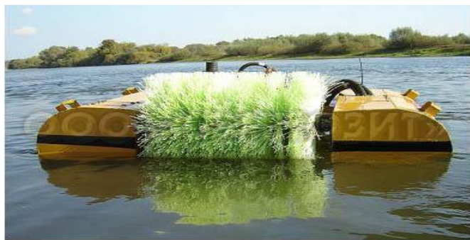
Рисунок 3.1.2.2 – Сбор разлитой нефти с поверхности водного объекта
