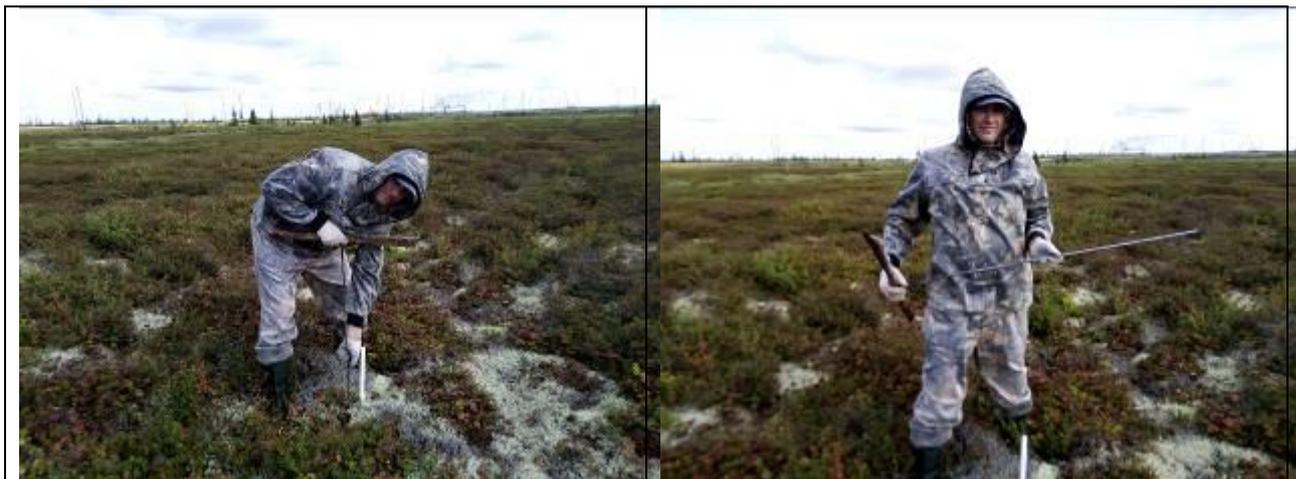
Рис 4.26-4.27 Замер глубин оттаивания грунта с помощью измерителего щупа
