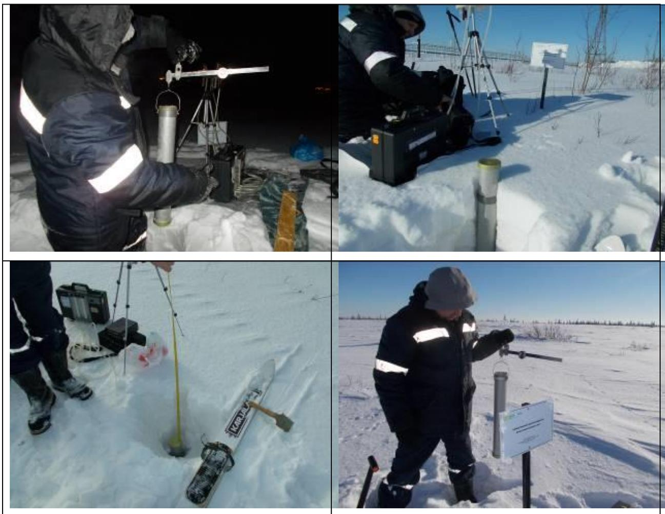
Рис. 4.5-4.8 Отбор проб снега. Определение плотности и мощности снежного покрова.
