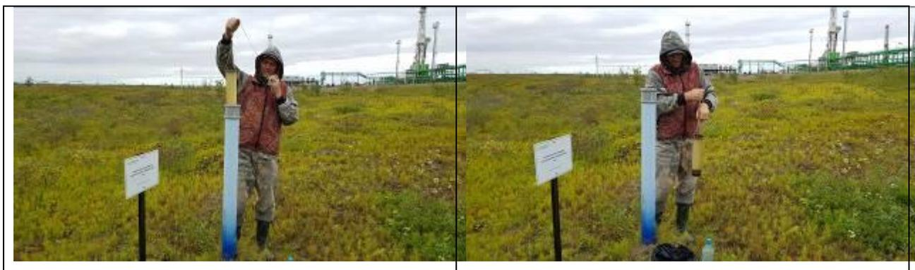
Рис. 4.18- 4.19 Отбор проб подземных вод на Харьягинском месторождении в августе 2019 г.
