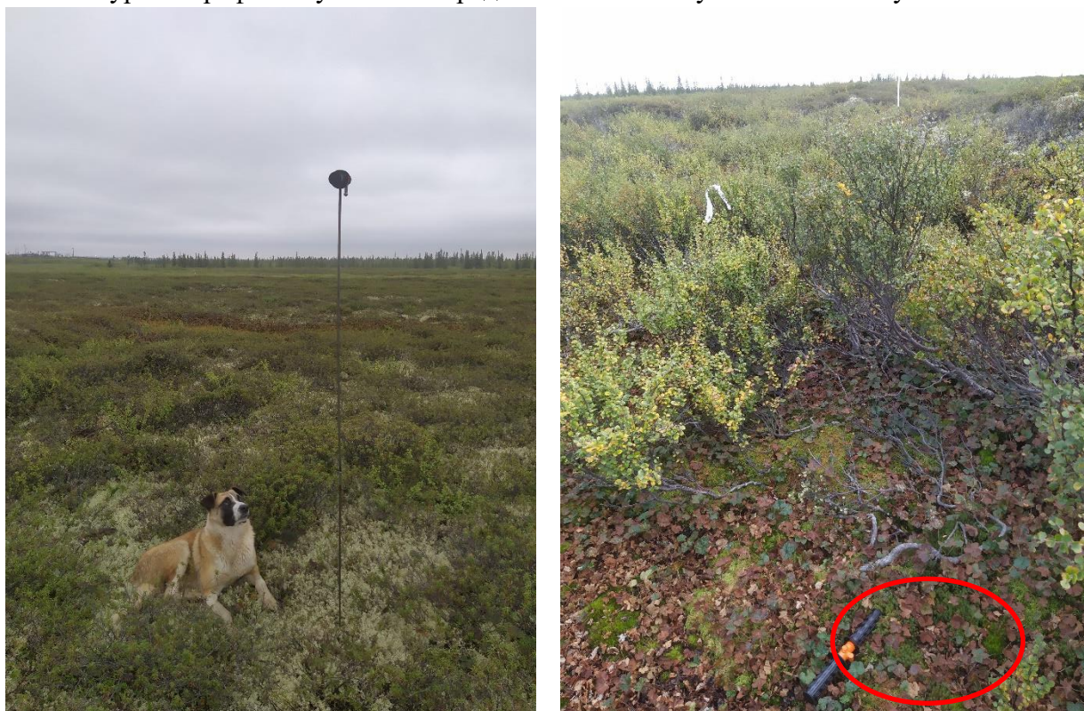
Рисунок 5.8-1 Проведение замера глубин оттаивания грунта с помощью измерительного щупа
